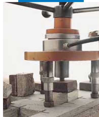
Zkouška tahové přidržnosti k podkladu (SATTEC)
